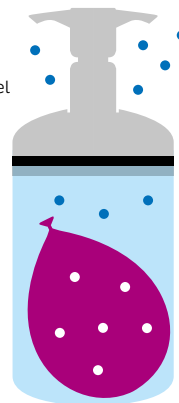
Figura 11. Situación en la que ya se ha extraído gran parte del aire del tarro de vacío
